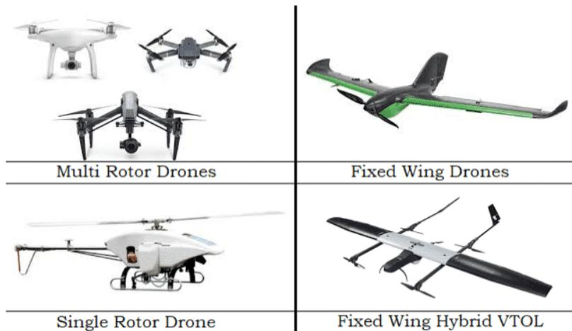
**Figura 1.** Tipología de UAV / drones. Fuente: CFD Flow Engineering (2024).
