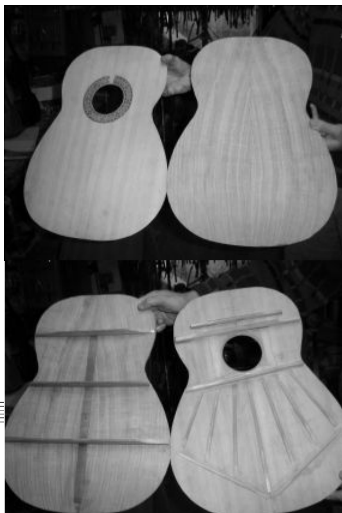
Fig. 3. Tapa y fondo de guitarra clásica. La vibración de la cuerda mueve la tapa, y la tapa mueve el aire para producir el sonido, por eso las propiedades de vibración de la tapa son fundamentales. El fondo interviene en menor medida, y por lo general es de una madera más densa.
