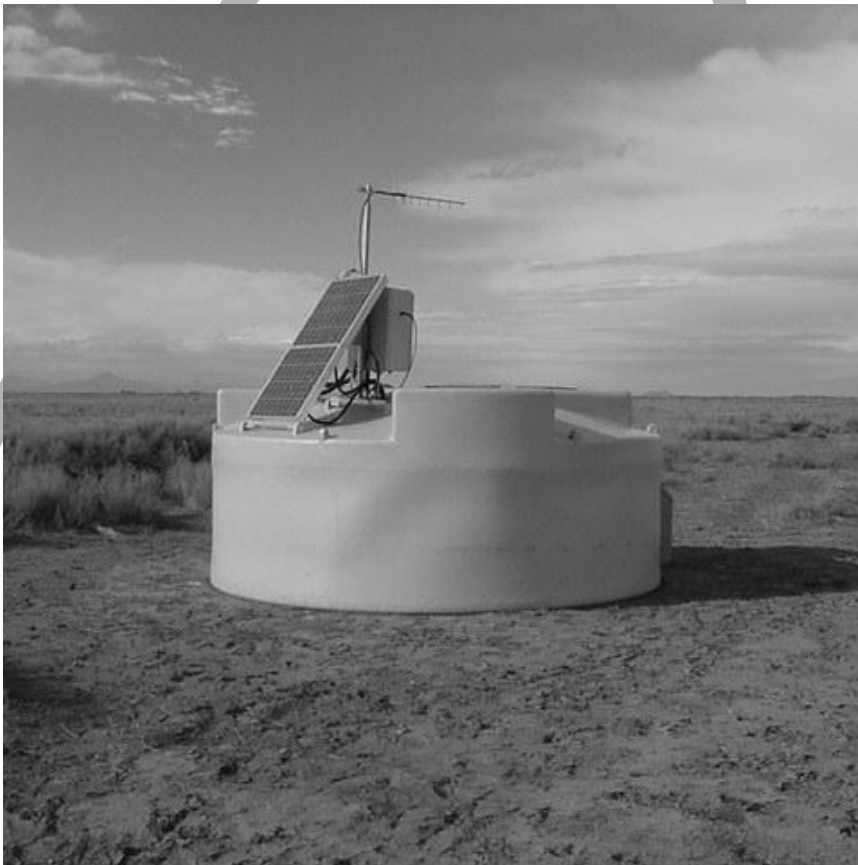
Fig. 3: Uno de los primeros detectores Cherenkov instalados en el campo. Cada detector contiene 12.000 litros de agua ultra pura, tres detectores fotosensibles y la electrónica asociada. El panel solar provee de energía a la unidad.
